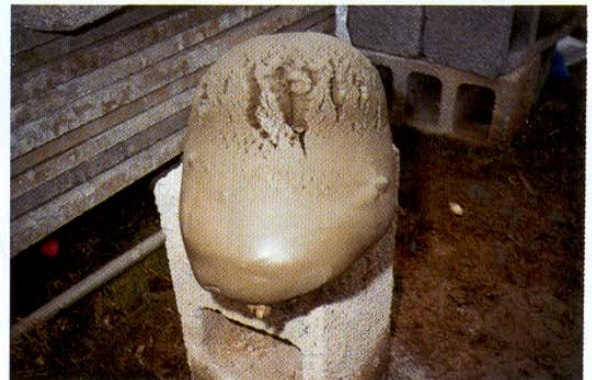
(d) 瞬結型之灌漿液固結後形成之灌漿體
